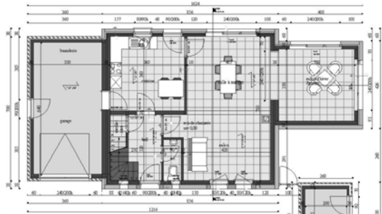
Rez-de-chaussée (niv 0,00 = géomètre 11,80) Ech:1/50
